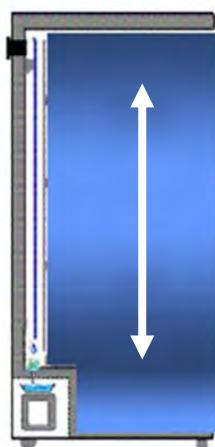
Во всем шкафу поддерживается одинаковая температура, и Вы можете использовать весь объем шкафа для длительного хранения всех типов вин (выбрав +12°C) или для подготовки к употреблению какого-то одного типа вина, выбрав подходящую температуру из диапазона от +8 до +18°C
