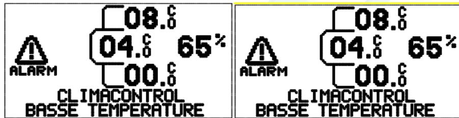
Этот сигнал может активироваться, если температура в помещении слишком низкая, или если дверь шкафа не закрыта продолжительное время, и в шкафу опускается температура из-за слишком низкой температуры в помещении.
