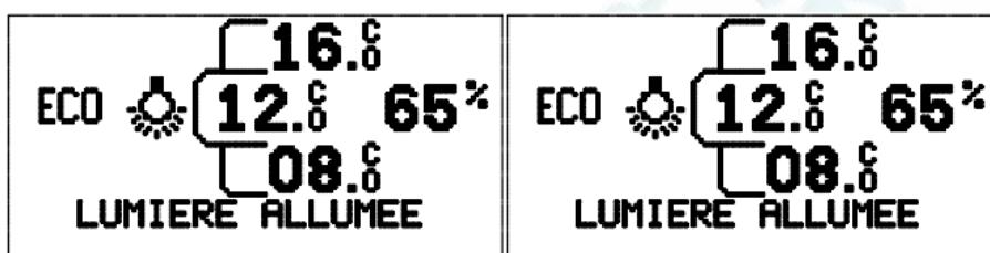
Можно активировать режим постоянной работы освещения. Для этого надо нажать и удерживать 5 сек. кнопку ▼ «DOWN». При этом на дисплее отобразится пиктограмма постоянной работы освещения (стр. 14). Для отключения режима нажмите кнопку ▼ «DOWN»
