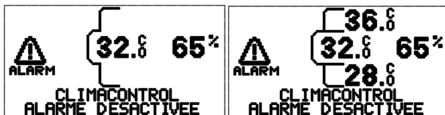
Если после одного часа работы шкафа параметры не возвращаются в нормальное состояние, аварийный сигнал снова активируется. Рекомендуется отключить устройство и вызвать технического сотрудника сервисного центра.
