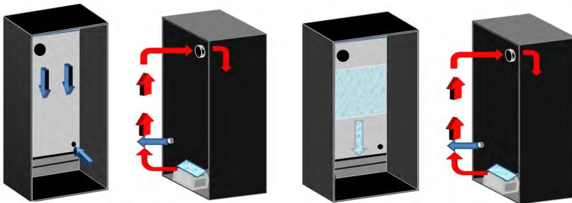
Винный шкаф производит холодный воздух, который тяжелее теплого воздуха, поэтому он медленно опускается вниз. Этот процесс создает давление, которое «выталкивает» воздух в отверстие, расположенное в нижней части прибора.
